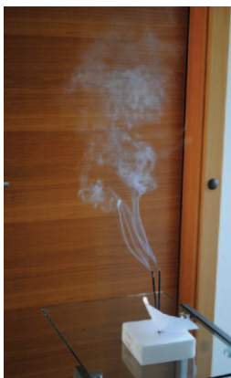
A jelzőfüst mutatja a helyiségben a légáramlat mozgási irányát
