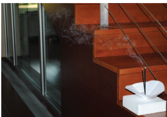
A lépcsőn haladó légáramlat az előszobába fordul le az adott helyen
