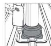
5. Rögzítse a Dektite-t önfúró csavarral vagy Bulb-tite szegeccsel
