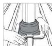
4. A Dektite-t pontosan formálja rá a profilmezére.
