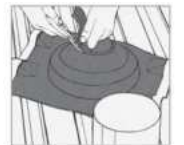
1. Illessze a Dektite-ot a csőhöz.
