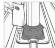
4. Rögzítse a Dektite-ot önfúró csavarokkal vagy Bulb-tite szegecsekkel.
