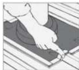
2. Illessze és jelölje a Dektite-ot a profilmezén.
