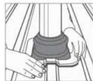
3. A Dektite illessze rá a tetőprofilra.
