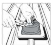
1. Illessze a Dektite-t a csőhöz.
