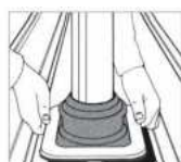
2. Illessze és jelölje a Dektite-t a profilmezén.
