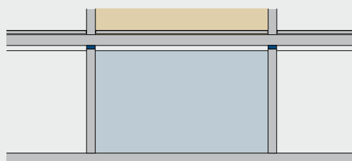
Mélygarázs/pince: födém alsó síkján elhelyezett hőszigetelés
