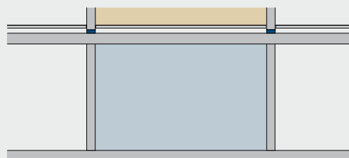
Mélygarázs/pince: födém felső síkján elhelyezett hőszigetelés
