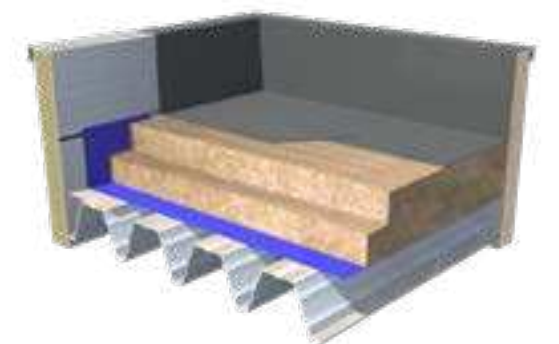
RAGASZTOTT RENDSZER BITUMENES FELÜLETRE Fatrafol 807 + Fatrafix PU ragasztó
