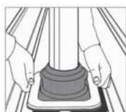
2. Illesse és jelölje a Dektite-t a profillemezen.
