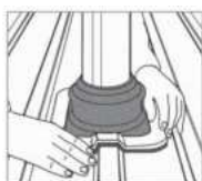
3. A Dektite illesse rá a tetőprofilra.
