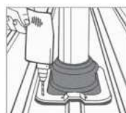
4. Rögzítse a Dektite-t önfúró csavarokkal vagy Bulb-tite szegecsekkel.
