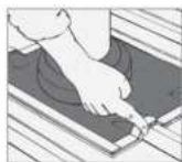
2. Illesse és jelölje a Dektite-t a profillemezen.
