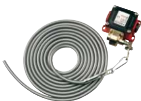
Húzókapcsoló műanyag húzókötéllal Vízszintesen vagy függőlegesen szerelhető, öntött alumínium ház, IP 65, kábel hossza 4 m
