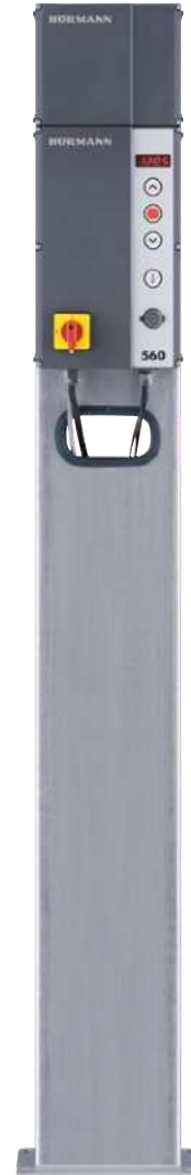
STI 1 vezérlő oszlop Max. 2 db bővítőházzal ellátott vezérlés szerelésre. Szín: fehéralumínium, RAL 9006, Méretek: 200 × 1660 × 60 mm (sz × ma × mé)
