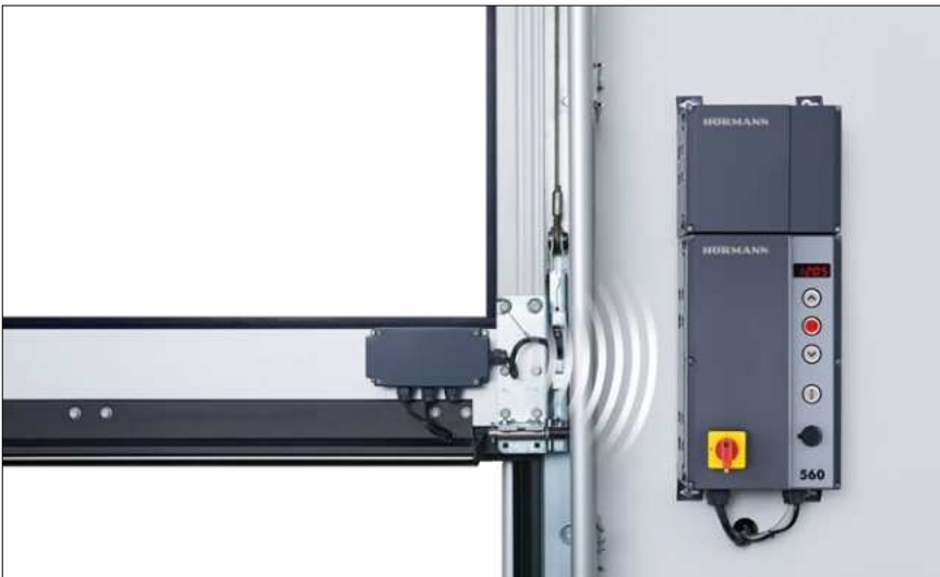
Rádiós átviteli egység a jelek átviteléhez a kapulaptól Bluetooth-on keresztül a vezérléshez (nincs spirálkabel), áramellátás nagy teljesítményű akkumulátoron keresztül; csatlakoztatható komponensek: LE (low energy) optoszenzorok, VL1-LE / VL2-LE előfutó fényzorompó, 8k2-élvédelmi kontaktsín, lazakötél-kapcsoló, személybejáró-ajtó érzékelő, reteszérzékelő
