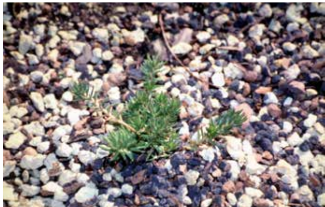
Ásványi zúzalékos „egyrétegű” ültetőközegek frissen ültetett szédum palántáival
