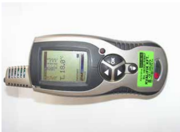
Elektronikus, digitális, memóriás páratartalom, levegőhőmérséklet, felületi hőmérséklet, harmatpont mérő műszer
