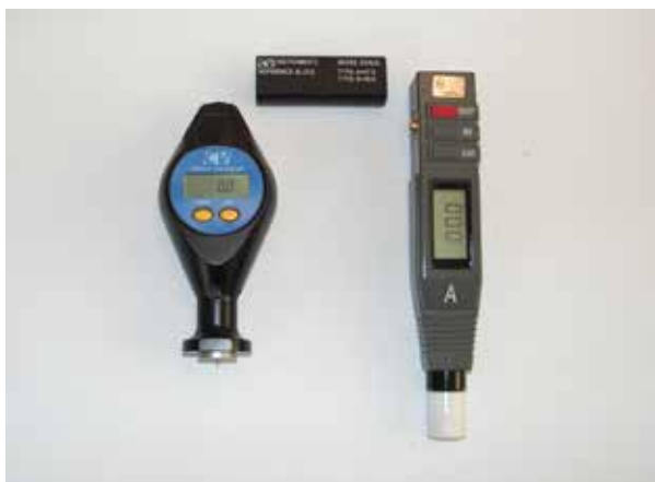
Digitális kijelzésű Shore A és D keménységmérők
