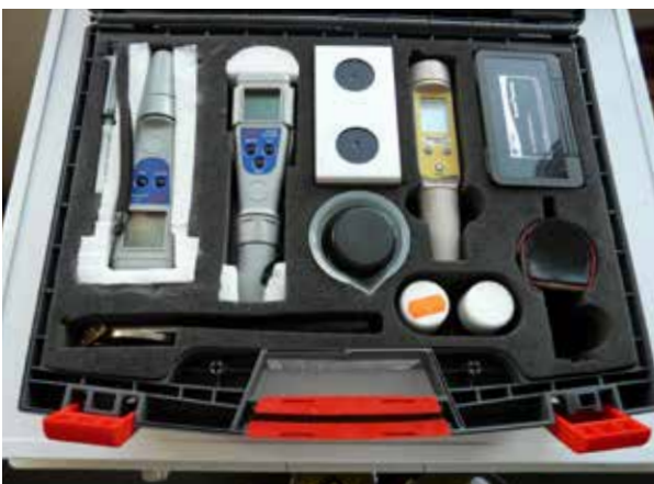
Eszközök az acélfelületek vízben oldható szennyeződéseinek mérésére
