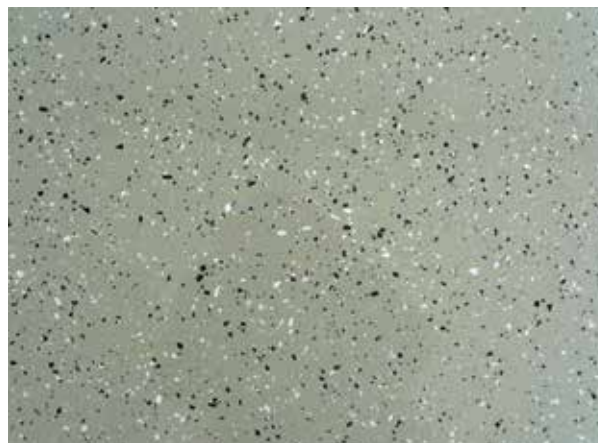
Műanyag chips beszórással készített bevonat megjelenése
