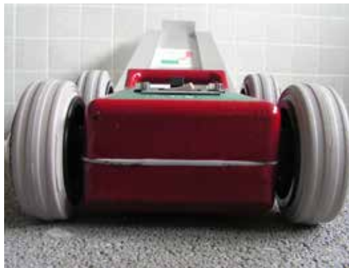
SlipAlert vizsgáló kiskocsi és rámpa
