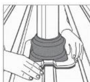
3. A Dektite illesse rá a tetőprofilra.
