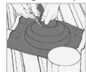
1. Illesse a Dektite-et a csőhöz.
