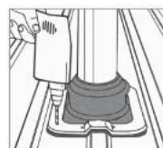
4. Rögzítse a Dektite-et önfúró csavarokkal vagy Bulb-tite szegecsekkel.
