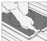
2. Illesse és jelölje a Dektite-et a profile-mezen.
