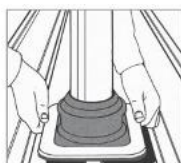
2. Illesse és jelölje a Dektite-et a profile-mezen.
