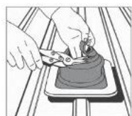
1. Illesse a Dektite-et a csőhöz.
