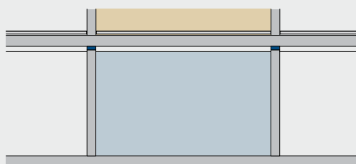
Mélygarázs/pince: földem alsó síkján elhelyezett hőszigetelés
