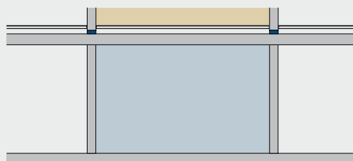
Mélygarázs/pince: földem felső síkján elhelyezett hőszigetelés
