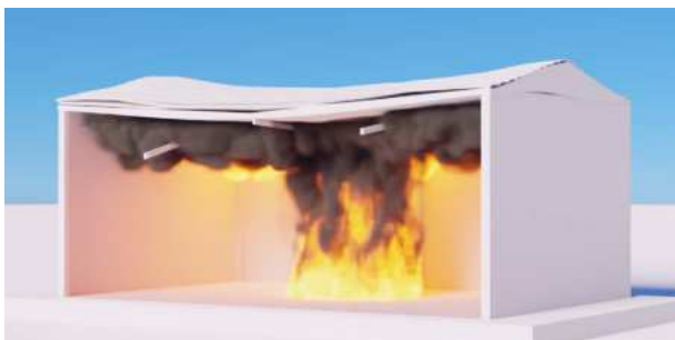
A teljes belobbanás (flashover) véglegesen megromlítja az épület szerkezetét, továbbá akadályozza a hatékony felderítést és mentést
